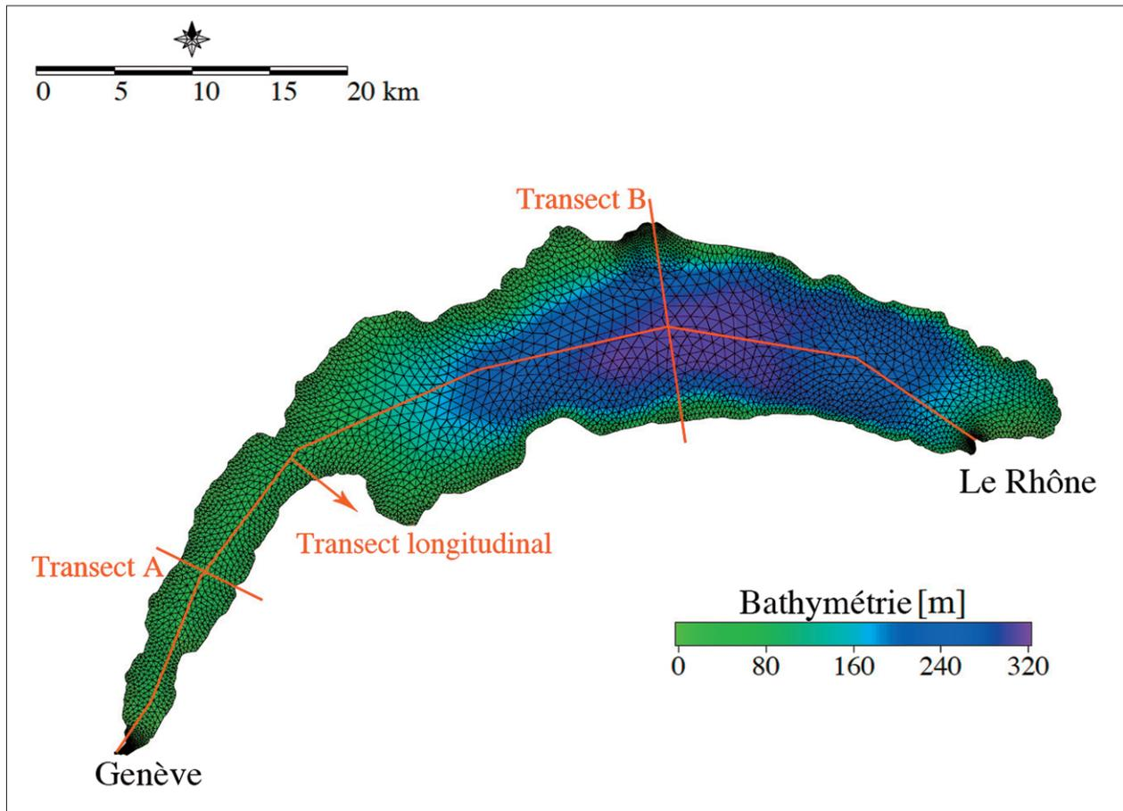
Fig. 2. Éléments finis appliqués sur la bathymétrie du Léman.
