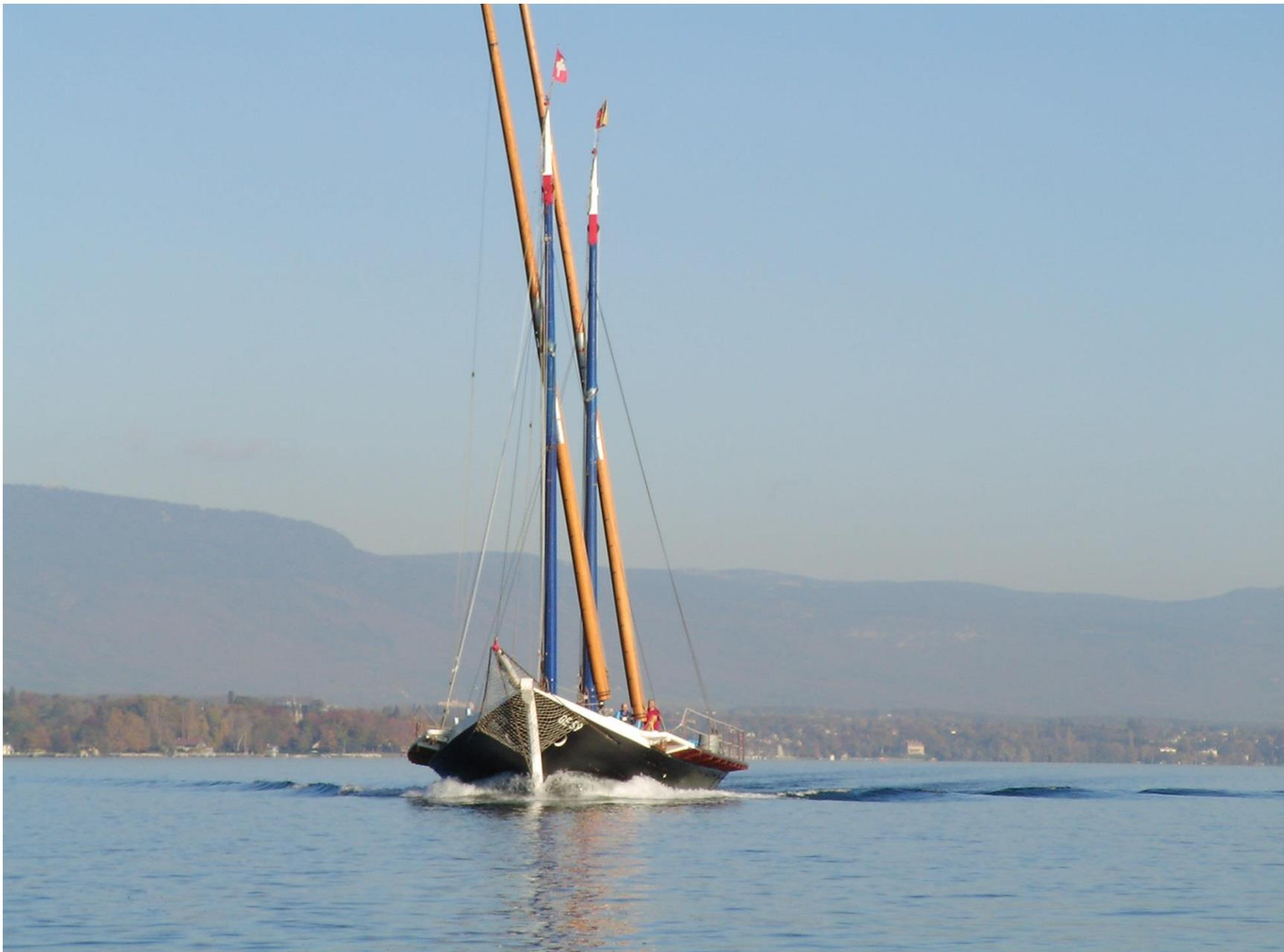
3 novembre 2005. Essais moteurs avec 22,5 tonnes de lest. 2100 t/min, 9kn/h
